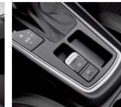
Freno de mano eléctrico con función Auto-Hold.
